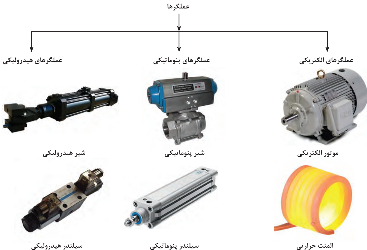
شکل ۲۶-۵- انواع محرک‌ها در سیستم‌های کنترلی
